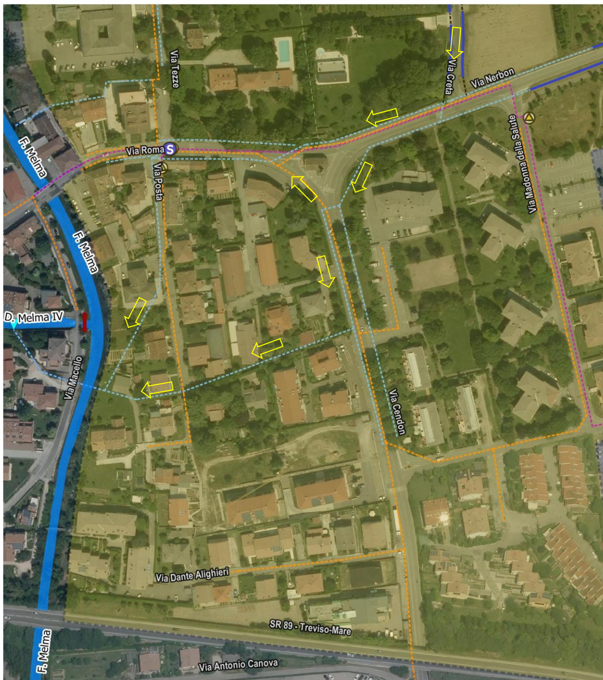
Figura 32. Particolare rete manufatto di sfiato incrocio via Roma.
