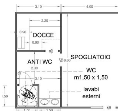
PIANTA Scala 1:100 Spogliatoio con servizi igienici.
