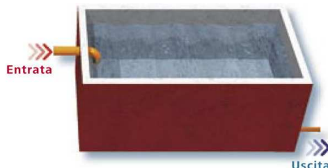
Schema funzionamento invaso concentrato sotterraneo di compensazione
