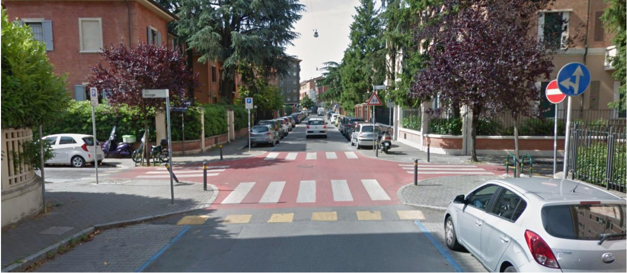
Fig. 4.2 – Esempio di sistemazione di incrocio rialzato
