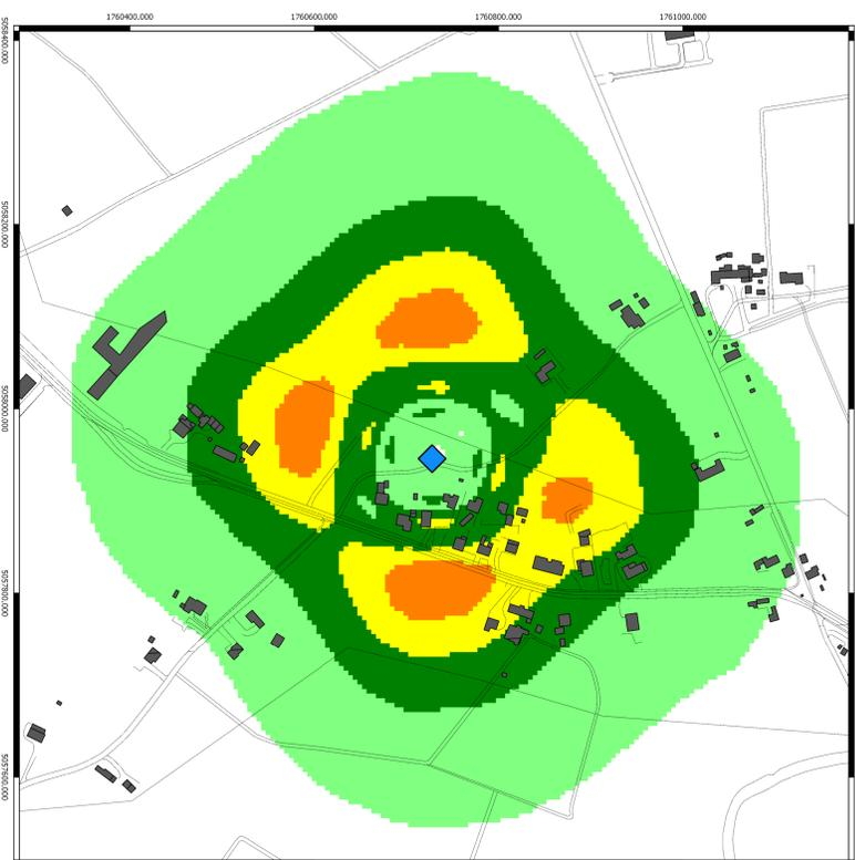
Campo elettromagnetico (V/m) calcolato alla quota di 11,9 m sul livello del terreno
