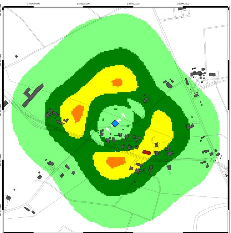
Campo elettromagnetico (V/m) calcolato alla quota di 9,9 m sul livello del terreno
