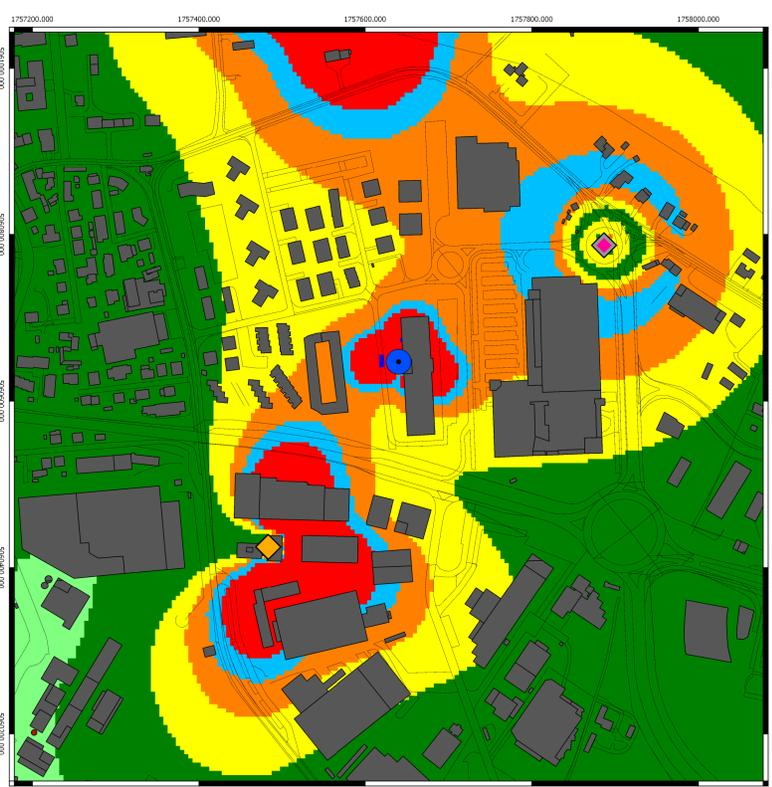
Campo elettromagnetico (V/m) calcolato alla quota di 21,3 m sul livello del terreno
