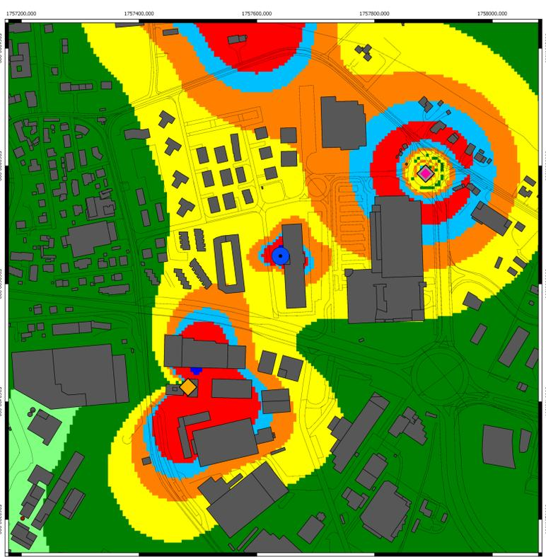
Campo elettromagnetico (V/m) calcolato alla quota di 23,3 m sul livello del terreno
