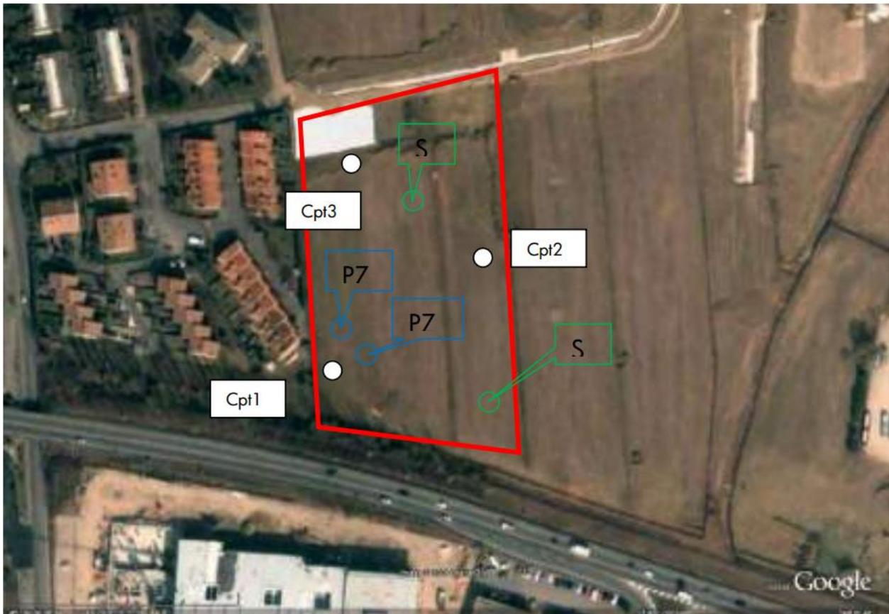
Fig. 12 Planimetria riportante la posizione delle prove penetrometriche
